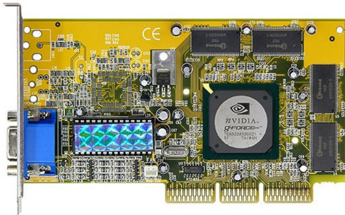
nVidia GeForce 256 – един от първите съвременни GPU (1999)
