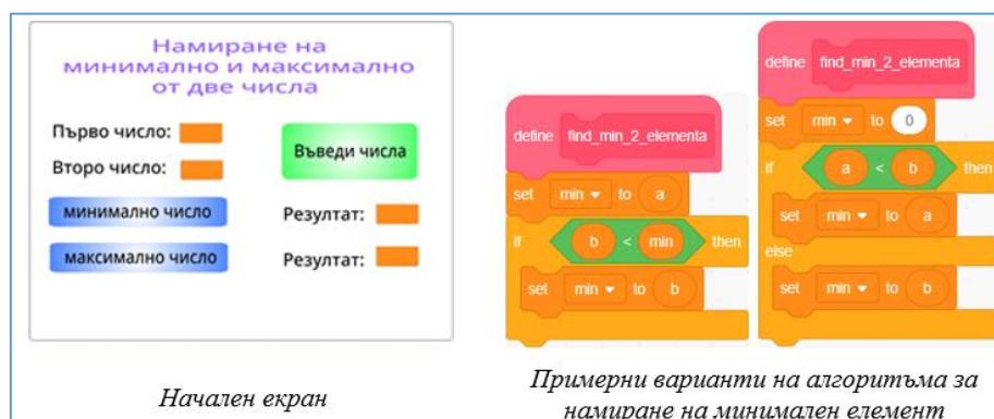
Фигура 2. Примерен модел на задачата и алгоритъм за намиране на минимален елемент на две числа
