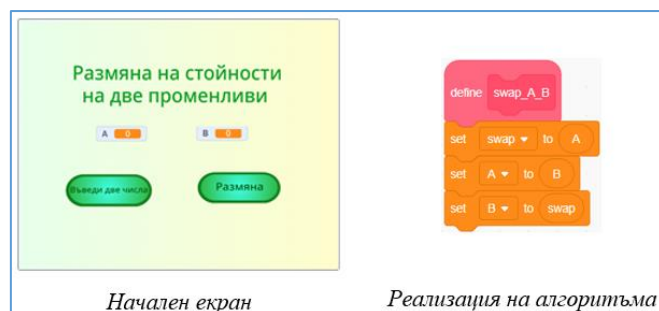
Фигура 1. Примерен модел на задачата и алгоритъм за размяна на стойности на две променливи
